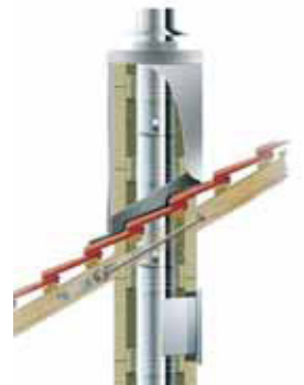
Beispiel: Stülpkopf Alu als Verkleidung über Dach.
